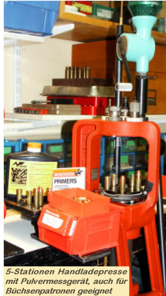
*5-Stationen Handladepresse mit Pulvermessgerät, auch für Büchsenpatronen geeignet*
